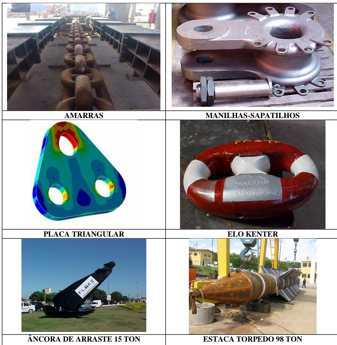
Figura I.2: Componentes de linhas de ancoragem de plataformas de petróleo [8].
